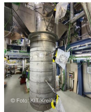
Abbildung 1: Partikelschüttung aus Keramikpartikel innerhalb des Tanks während des Füllvorganges (links) und vollständig instrumentierter Speichertank vor der Isolation (rechts).
