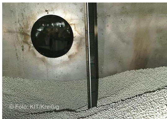
Abbildung 1: Partikelschüttung aus Keramikpartikel innerhalb des Tanks während des Füllvorganges (links) und vollständig instrumentierter Speichertank vor der Isolation (rechts).
